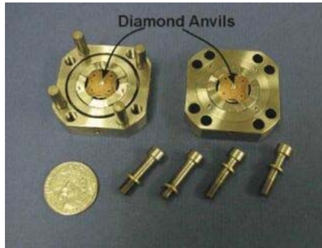
Kuva 4. DAC-laitteissa tarkasti hiotut timantit asetetaan metallilevyjen avulla samalle akselille. www.crystal.vt.edu
