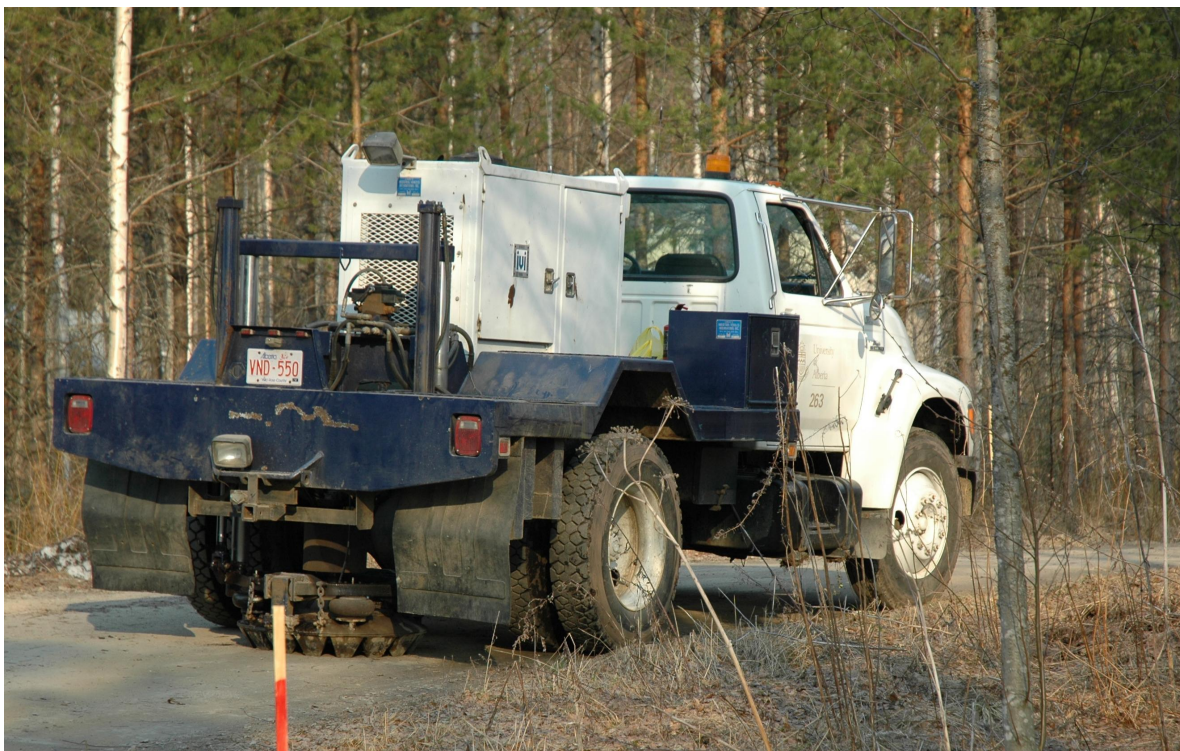
Kuva 3.3. Albertan yliopiston vibraattoriauto IVI Minivib™, jota käytettiin seismisissä heijastusluotauksissa Outokummussa keväällä 2006. Auton takaosassa oleva metallilevy painettiin lujasti maata vasten ja maata täristettiin noin 8 sekunnin ajan. Outokummussa käytettiin lineaarisesti kasvavia taajuuksia 15-250Hz.
